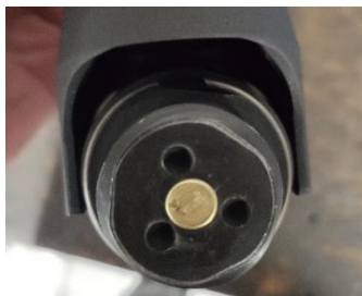
Nabój zakleszczony w zamku
